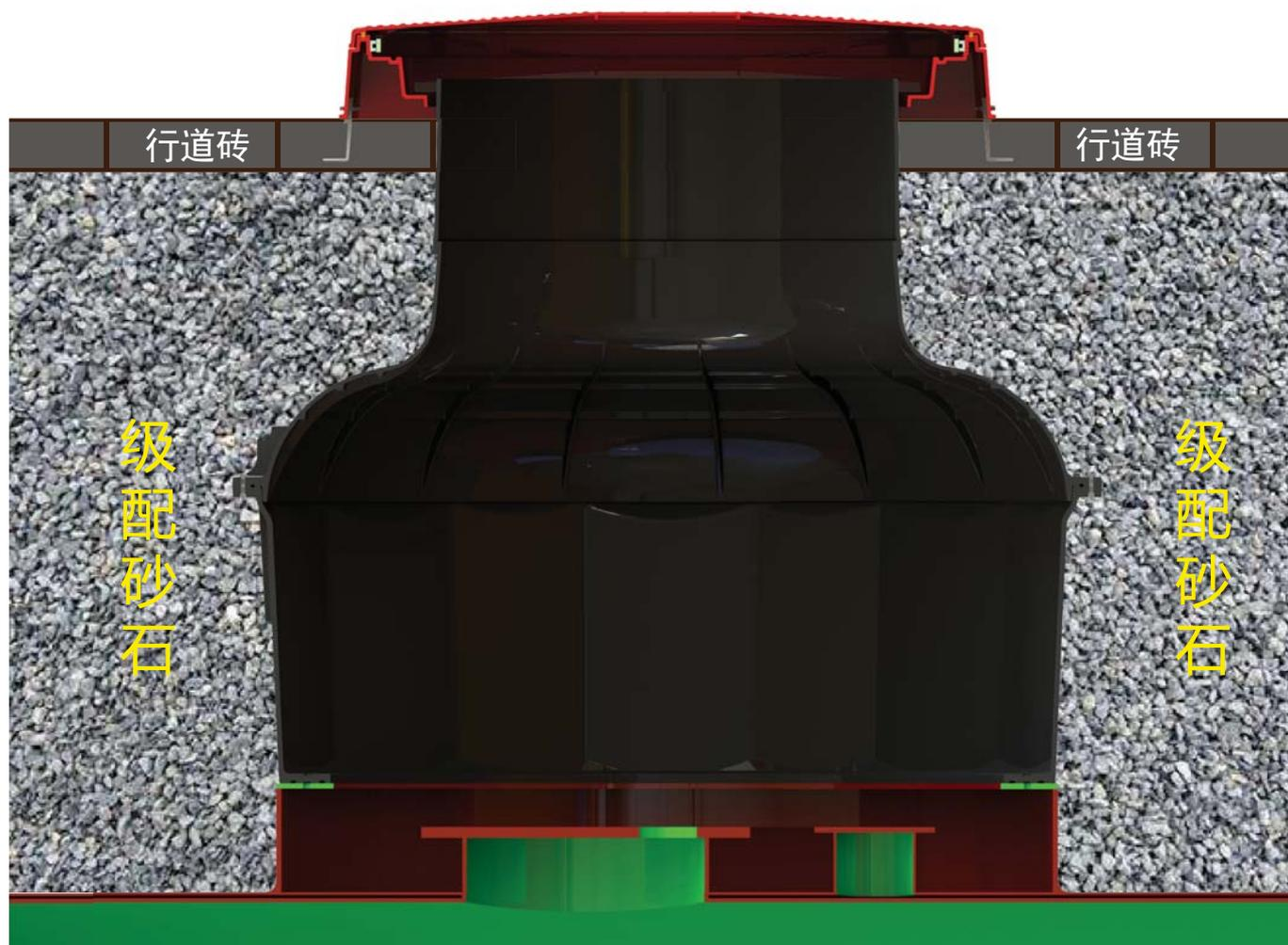
**注意：**人孔操作井和管线安装完成后，在人孔井确认高度后（人孔井口高于人行道砖6CM以上），回填级配砂石，铺人行道砖，把安装好底板的彩色非承重井盖安放到人行道砖上面，固定脚埋进地坪内，人孔井口和井盖配合缝隙抹胶密封或素水泥填缝处理。
