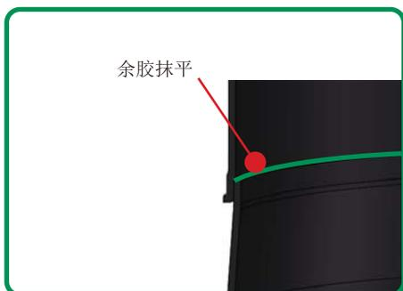
放井筒上节，压力压紧，螺杆紧固后抹平缝隙，如上图
