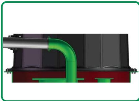
油罐法兰面涂上密封胶后放密封垫，密封垫和油罐法兰安装孔对齐后，密封垫也涂一圈密封胶然后把井筒下节放到上面，安装孔对齐后穿螺栓紧固，在短时间内安装调整避免密封胶凝固。
